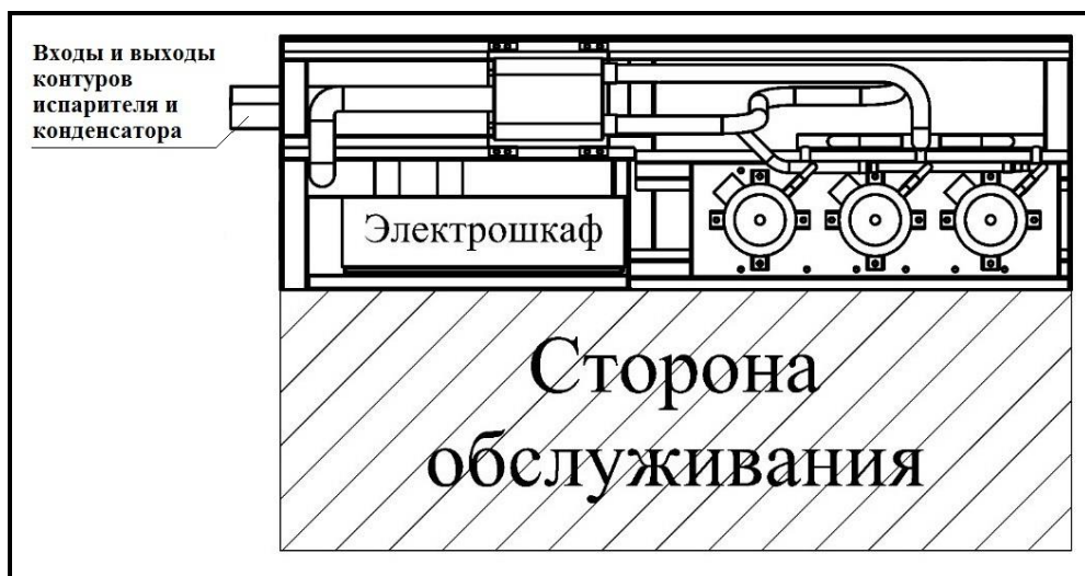
Рисунок 1.7.1. Схема установки одиночного чиллера.
