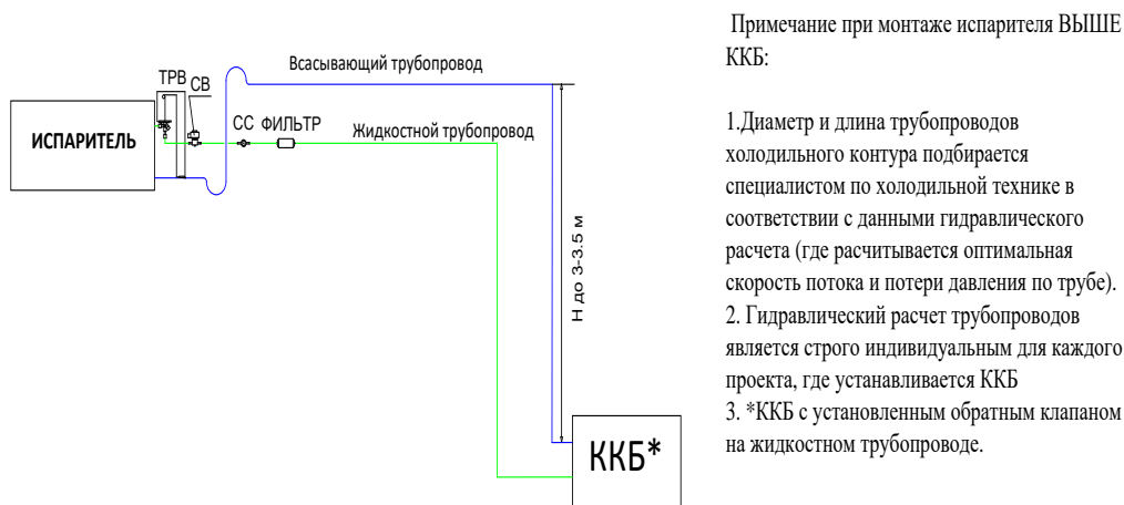
Рис.9.9. Рекомендации при монтаже испарителя выше ККБ
