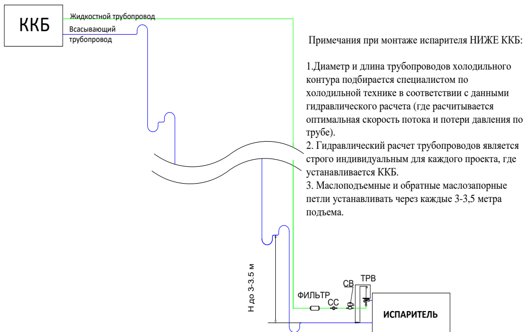
Рис.9.8. Рекомендации при монтаже испарителя ниже ККБ
